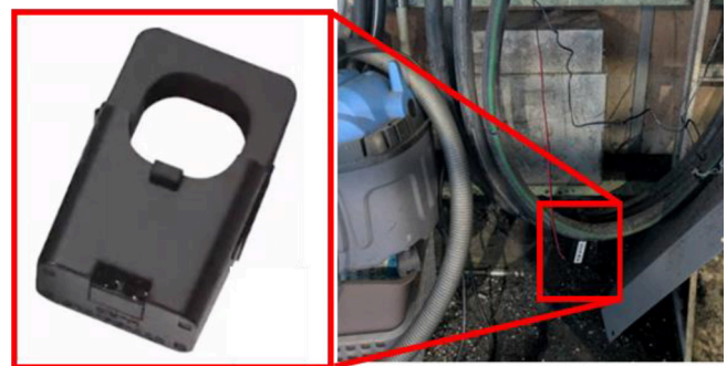
<電流センサの配電盤への設置>
